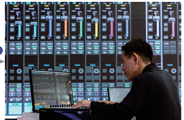
富ヶ谷のT-2音声の中継車に極超低遅延伝送されてきたライブの音声・映像を、幕張のInter BEE会場のNHKテクノロジーブースから同社のサウンドエンジニアがリモートプロダクション。中継車の音声卓をフルコントロールし、ボーカルや各楽器の音のバランス調整や音色調整などを行い、ブース内で上演した。送受信にはミハル通信製「ELL Lite」を使用
