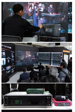
富ヶ谷のT-2音声の中継車に極超低遅延伝送されてきたライブの音声・映像を、幕張のInter BEE会場のNHKテクノロジーブースから同社のサウンドエンジニアがリモートプロダクション。中継車の音声卓をフルコントロールし、ボーカルや各楽器の音のバランス調整や音色調整などを行い、ブース内で上演した。送受信にはミハル通信製「ELL Lite」を使用
