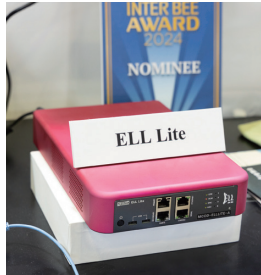
エンコーダー/デコーダー「ELL Lite」。プロフェッショナルオーディオのインターフェースを実装し、DanteとMADIの入出力、映像・音声の極超低遅延伝送などの機能を備えている
