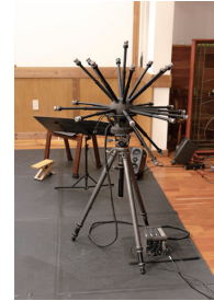
ホールでフラメンコを収録した22.2chマイクロフォン「ELLマイク」。22個の単一指向性マイクを搭載している。最適な位置に容易に移動して収録できる
