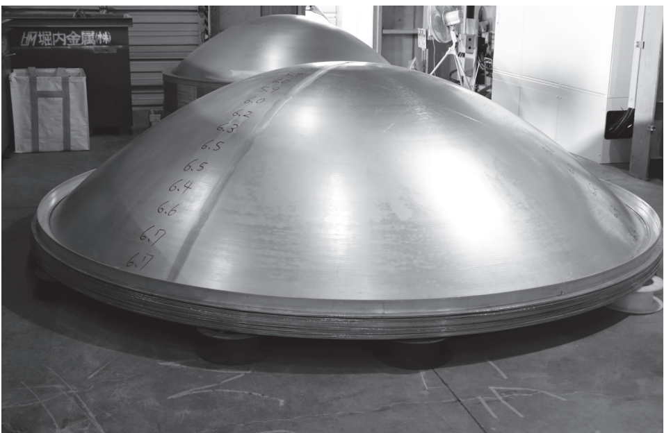
①⑥工場内のパラボラアンテナ製造過程
