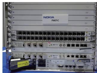
伊藤忠ケーブルシステムが展示したNOKIAの10G G-PONソリューション。「FWLT-Cラインカード」は、デュアルSFP、2.5Gbps、10GbpsなどのSFPを混載したサービス提供が可能だ
