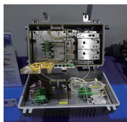
ミハル通信のFTTH中継装置は、サブセンターを設置することなく伝送距離を約20km延ばせる。地域のニーズに応じて、映像ユニットと通信ユニットの組み合わせを変えることができる
