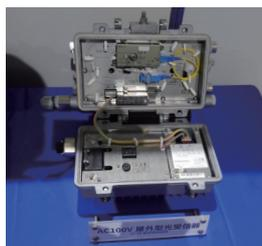
ミハル通信のHFC巻取りソリューションは、既存のEAを屋外型光受信器に置き換える方式。電源はAC100Vに対応しているため、PS設備を撤去できるのも利点だ
