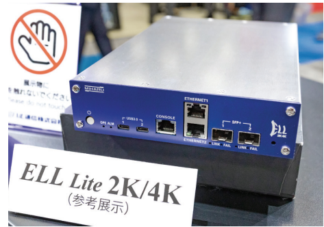
「極超低遅延音声伝送システム」。4K・HD 伝送向け極超低遅延映像伝送システム「ELL Lite 2K/4K」に実装した
