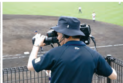
「絆スタジアム」の一塁カメラ、球追いカメラ、実況席カメラなどの4K映像は光回線でアイ・キャンに伝送し、同社の調整室でスイッチングした
