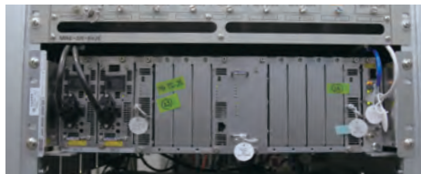
ミハル通信のMDSRシリーズの SI/MUX QAM変調器、高度JC-HITS TM
